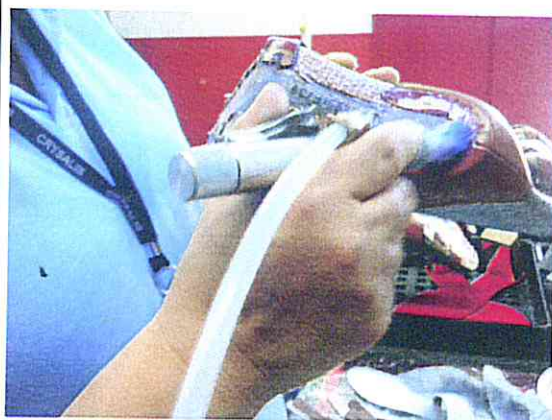
Aplicar adesivo com pistola pneumática
