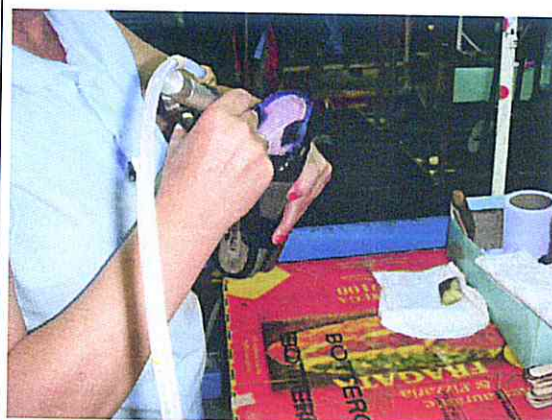
Aplicar adesivo com pistola pneumática
